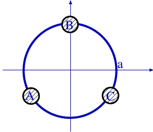
少しだけ捕捉をしておく。まず、一般性を失うことなく、3つの電荷のうちの一つの座標を  $y$  軸上に座標  $(0, a)$  置くとする。この電荷が静止するためには、接線方向の力、つまり残りの2つから働くクーロン力の合力のうち  $x$  成分がゼロになっていることが必要である。 $y$  成分はリングの拘束力がそれを支えてくれる。図のように  $B$  を  $y$  軸上に置いたとすると、残りの  $A, C$  の位置をそれぞれ  $(x_A, y_A), (x_C, y_C)$  とする。もちろん、リング上にあるので、 $x_A^2 + y_A^2 = x_C^2 + y_C^2 = a^2$  である。このとき、 $B$  に働く力の  $x$  成分、 $F_x$  は、
