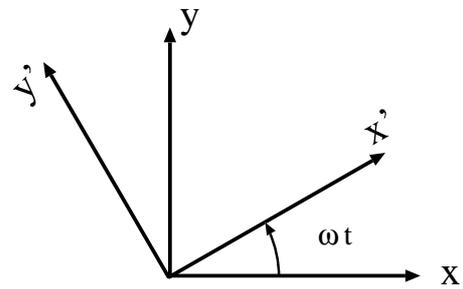
(b) 細い管が点  $O$  を中心として , 水平面内で一定の角速度  $\omega$  で回転している (右下図) . 時刻  $t = 0$  で管の内部の点  $O$  からの距離が  $l$  の位置に静止していた質点の運動を考える . 管の中では摩擦はないものとする . 管から受ける抗力を  $R$  として , 前問の結果を用いて運動方程式を書け . 質点はどのように運動するか .
